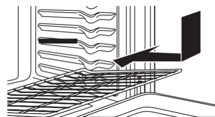
Pour remettre les grilles
